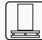
• As pilhas devem ser colocadas sobre estrados afastados da parede em local arejado e seco, sem contato direto com as paredes e não devem ultrapassar no 1,5 metros de altura.
